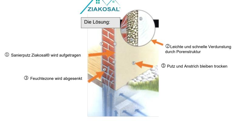
Salze kristallisieren in den Poren aus, ohne Schaden anzurichten
